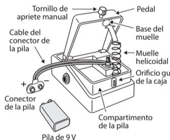
2. Extraiga la pila vieja del compartimento y quite el cable del conector de la pila.
