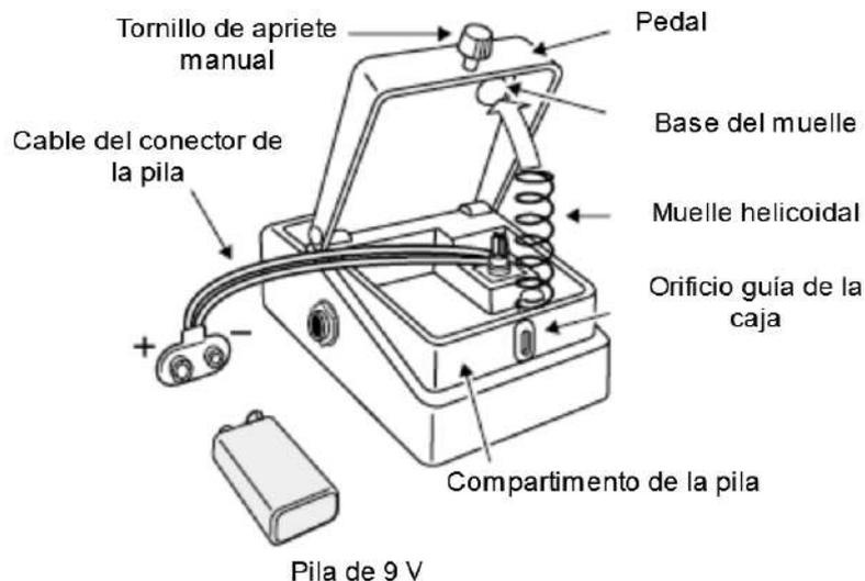
1. **Mantenga pisado el pedal y afloje el tornillo de apriete manual; a continuación, abra el pedal hacia arriba.**
