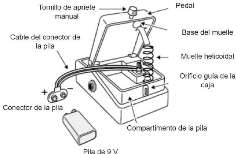
1. **Mantenga pisado el pedal y afloje el tornillo de apriete manual; a continuación, abra el pedal hacia arriba.**
